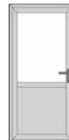
deur met 1 onderbreking, veiligheidsglas en 30 mm stalen vulling
